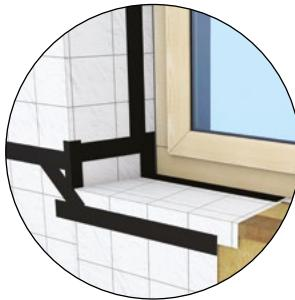
**À noter :** ce calepin, pour cet exemple de traitement de l'interface, décrit la mise en œuvre de la bande membrane pare-vapeur et d'un adhésif. Cela peut également être réalisé à l'aide d'un adhésif pré-plié.
